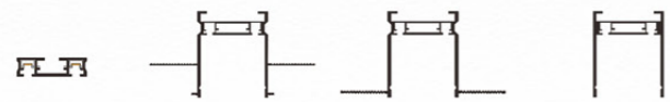
明装超薄导轨 嵌入式专用导轨 嵌入式专用导轨 明装/吊线专用导轨
